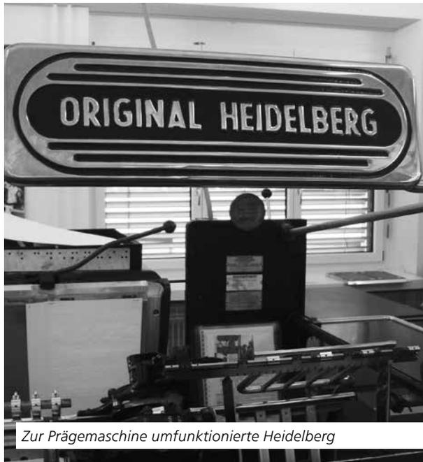
Zur Prägemaschine umfunktionierte Heidelberg
